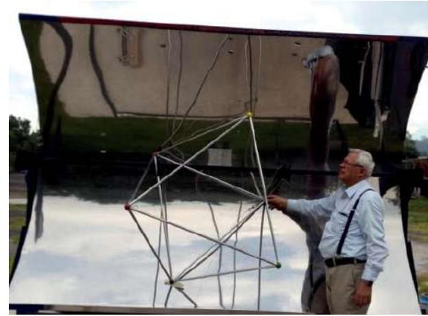
Uso de un artefacto de referencia para determinar errores de la superficie parabólica de un concentrador solar (2019)
