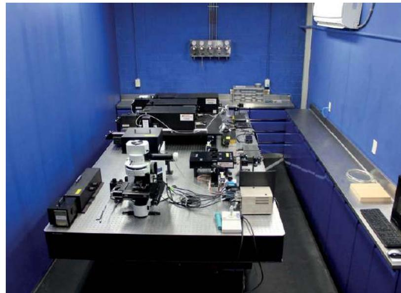
Raman Dispersivo TriVista 557, instalado en el Laboratorio Universitario de Caracterización Espectroscópica (LUCE)
