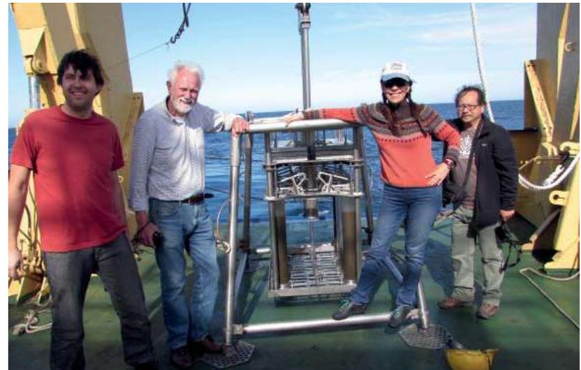
Nucleador de 8 tubos para el CICESE. Izquierda: mi alumno Jorge Apan y Barreto ensamblándolo en el Taller. Derecha: Científicos posando con el nucleador con tubos llenos de sedimento en el Buque Oceanográfico “El Puma”. (2015-2016)
