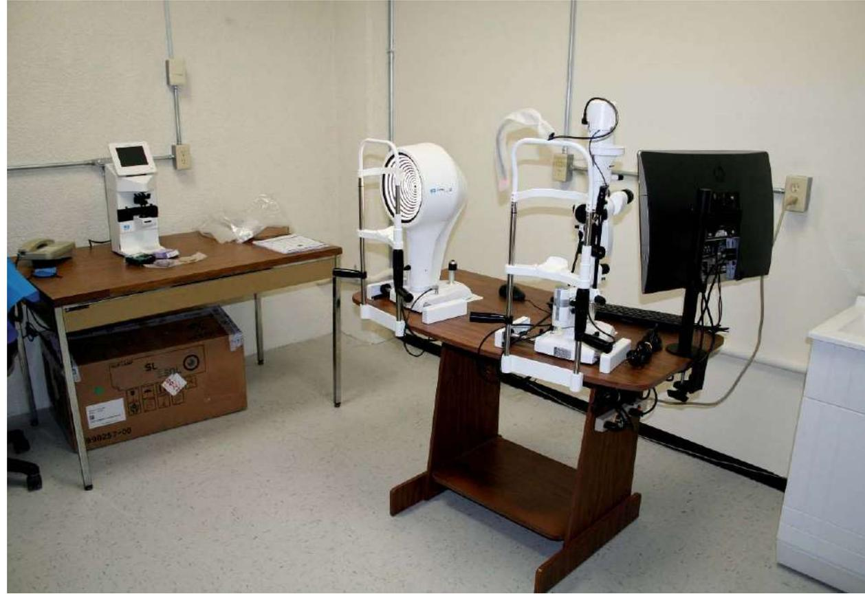
Laboratorio Nacional de Óptica de la Visión en donde se puede ver parte de los equipos instalados en el área clínica. De izquierda a derecha, un lensómetro, un topógrafo corneal y una lámpara de hendidura, con la computadora para su control
