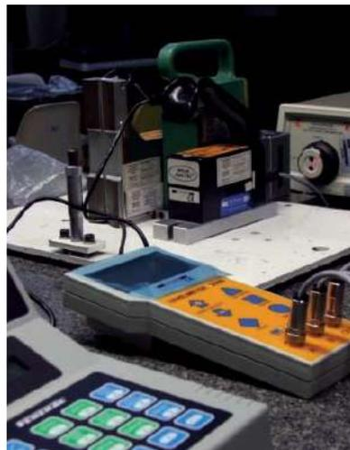
Calibración de nivel electrónico utilizando como referencia un sistema de medición láser
