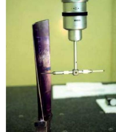
Ingeniería de reversa y síntesis geométrica de álabes de turbina de vapor para el IIE
