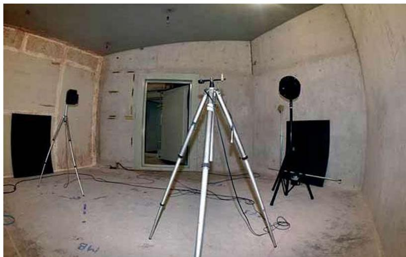
Mediciones acústicas en la cámara de transmisión
