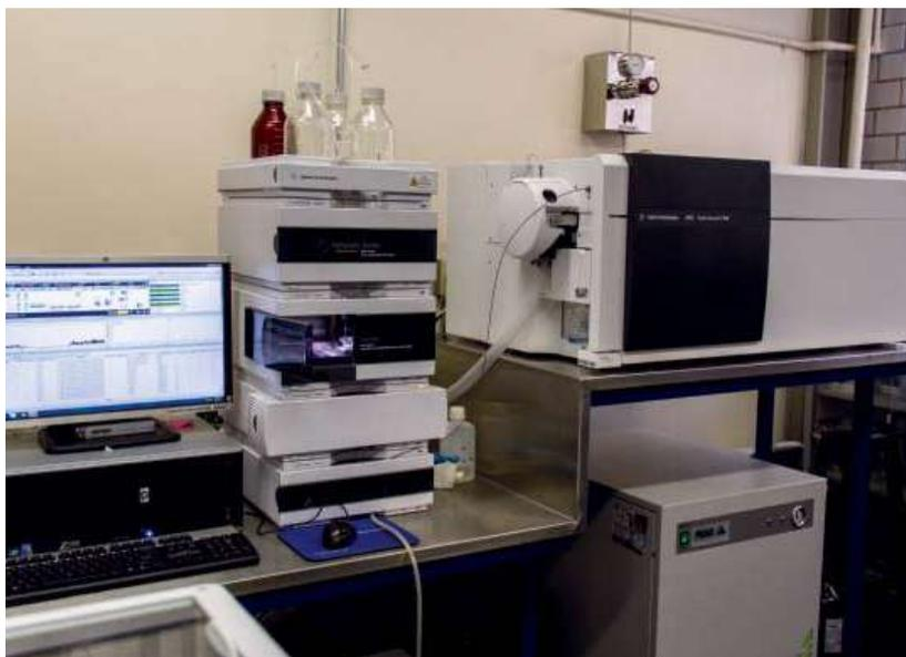
Cromatógrafo de líquidos acoplado a un detector de masa con triple cuadrupolo, instalado en el Laboratorio Universitario de Nanotecnología Ambiental (LUNA)
