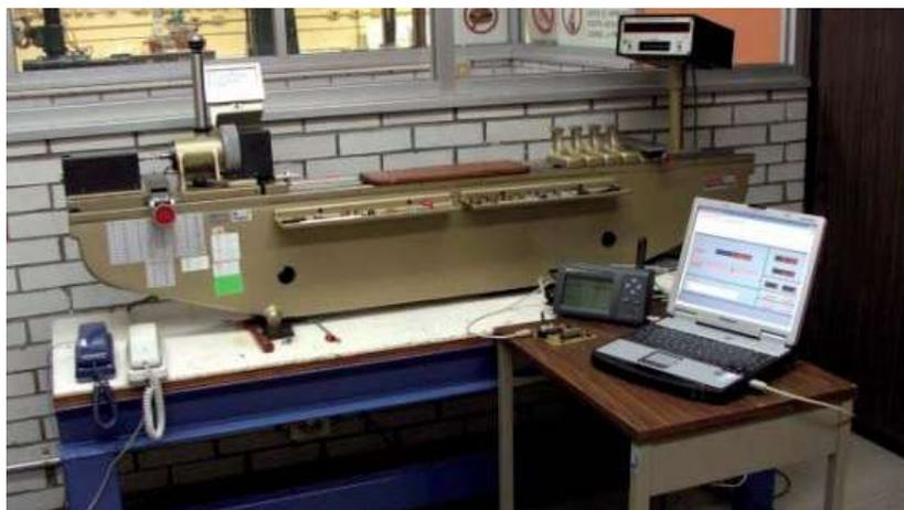
Máquina de referencia para medición de longitud, alcance 1000 mm, resolución 0,1  $\mu$ m
