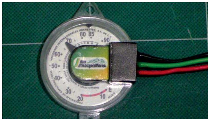
Prototipo terminado del medidor de nivel de gas en tanque estacionario
