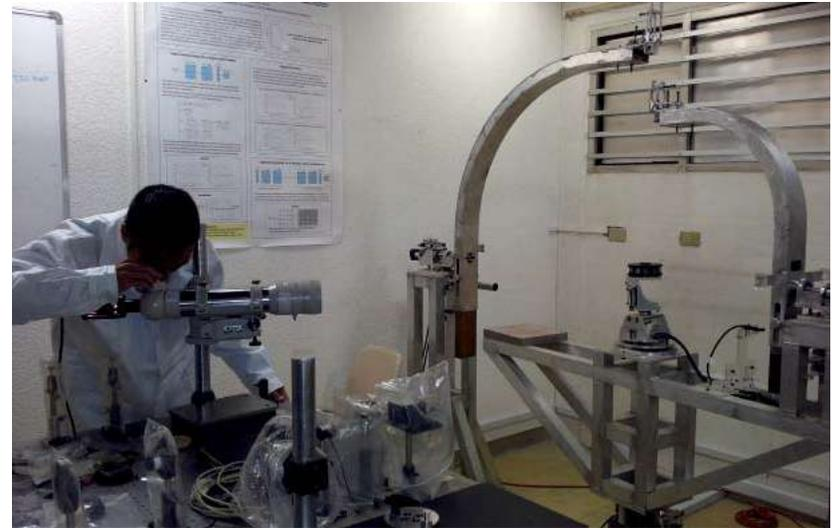
Desarrollo de un esparcímetro goniométrico para medición polarimétrica de la luz esparcida en superficies rugosas. Izquierda: pruebas en el Taller. Derecha: calibración del equipo en el laboratorio de Neil Bruce en el CCADET. (2015)
