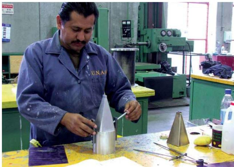
Prensa para fijar las piezas de la antena
